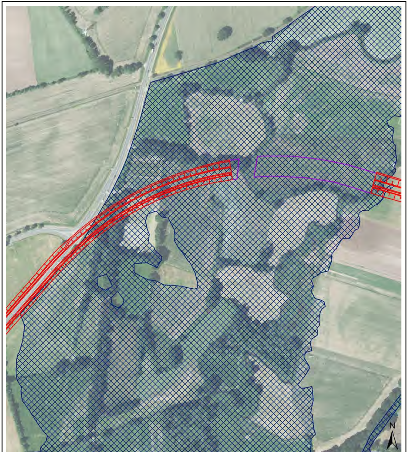
Bild 6.2 Retentionsraumverlust durch den Straßendamm der Variante 1-L beim HQ_{100} im ÜSG der Luhe Öffnungen wie geplant / minimal Maßstab 1 : 4.000
