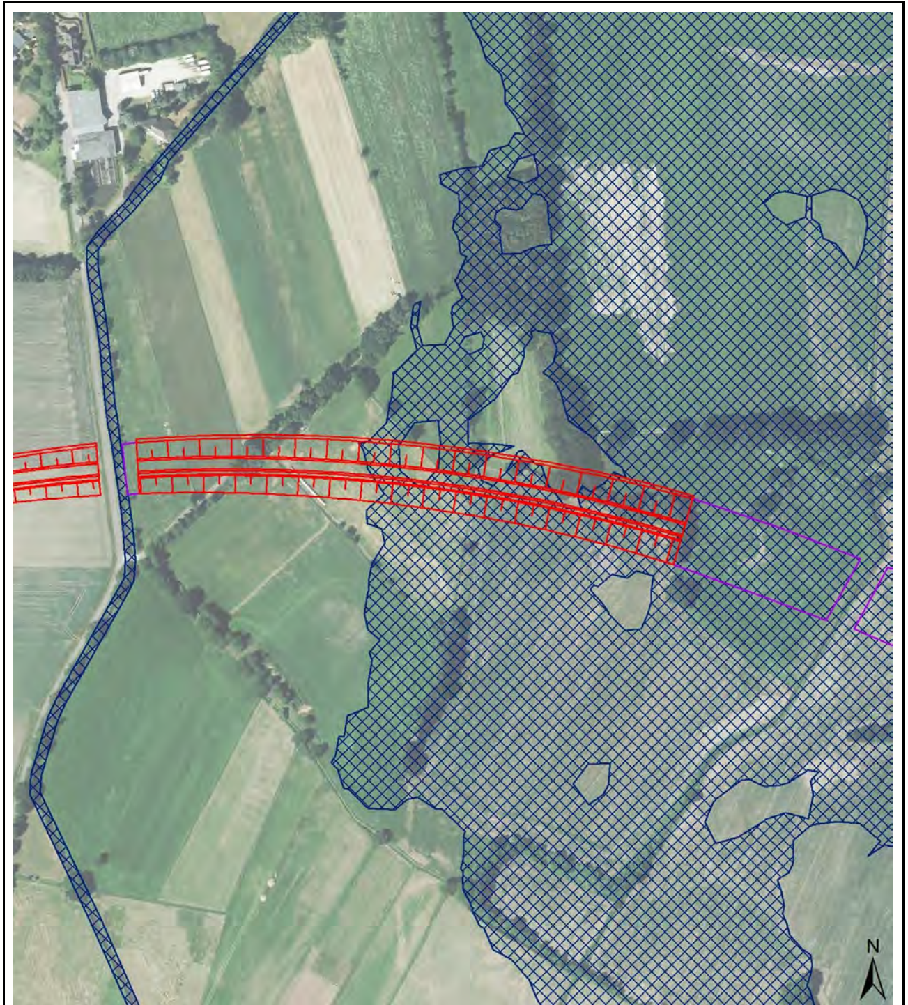
Bild 6.4 Retentionsraumverlust durch den Straßendamm der Variante 2.1 beim HQ_{100} im ÜSG der Luhe Öffnungen wie geplant / minimal Maßstab 1 : 4.000
