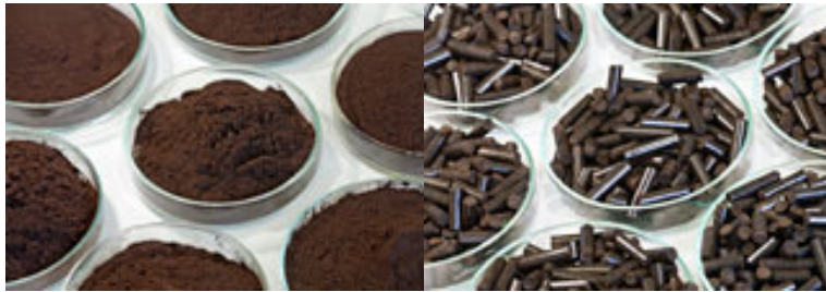
ABBILDUNG 16: PRODUKT EINER HTC-ANLAGE, LOSE UND PELLETIERT (QUELLE: SUNCOAL INDUSTRIES)
