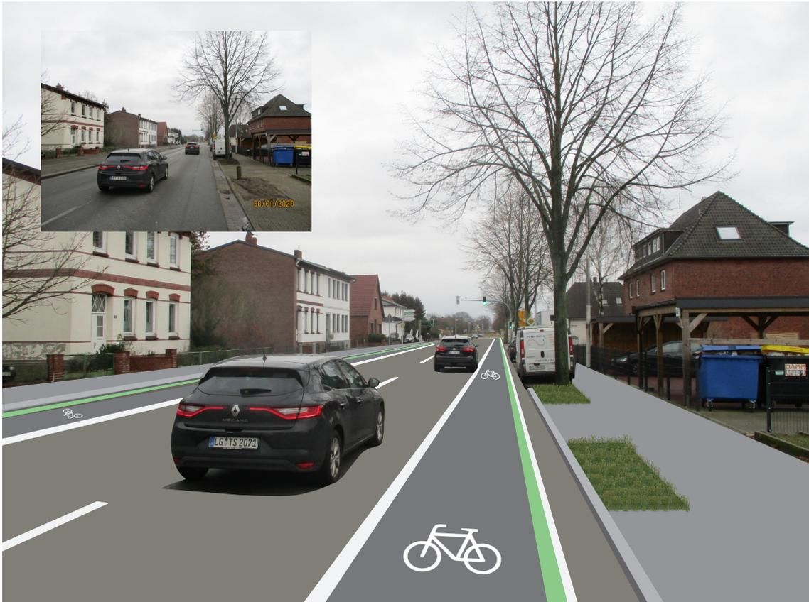
**Abb. 5.5** Visualisierung der Umsetzung des Radschnellwegs in der Lüneburger Straße in Winsen (mit Vergleichsfoto der Bestandssituation) (Quelle: ARGUS)
