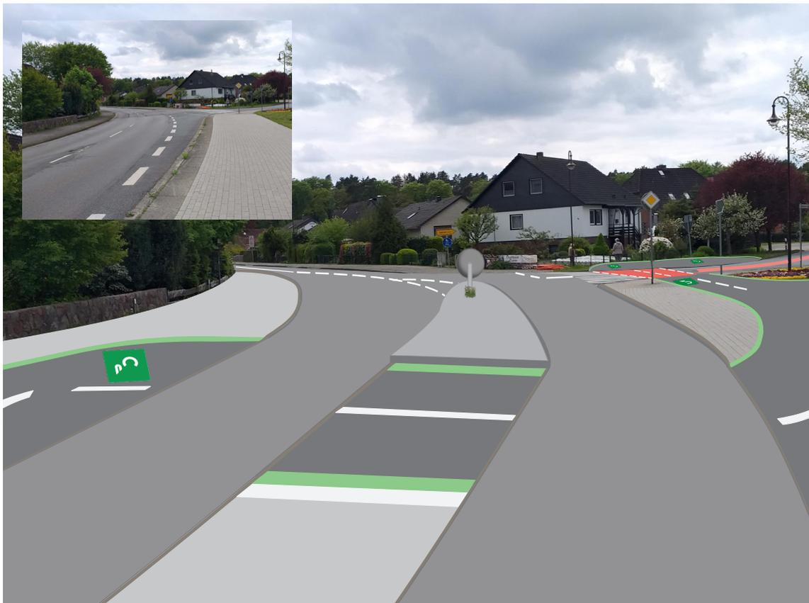
**Abb. 5.6** Visualisierung der Umsetzung des Radschnellwegs an der Einmündung Radbrucher Weg in den Vögelscher Weg in Bardowick (mit Vergleichsfoto der Bestandsituation) (Foto: Torben Ziel, Visualisierung: ARGUS)
