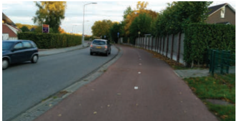
Zielbild straßenbegleitender Zweirichtungsradweg (Bsp. aus Weurt/Niederlande)
