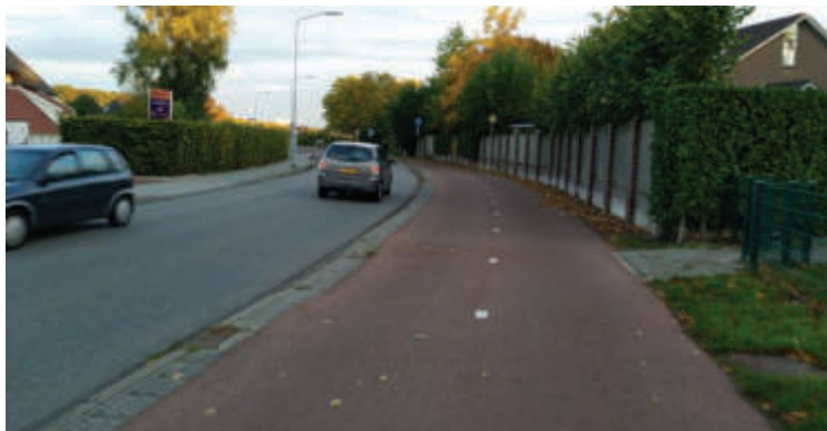
Zielbild straßenbegleitender Zweirichtungsradweg (Bsp. aus Weurt/Niederlande)
