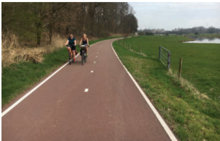
Zielbild selbstständig geführter Zweirichtungsradweg (Beispiel aus Nijmegen/Niederlande)
